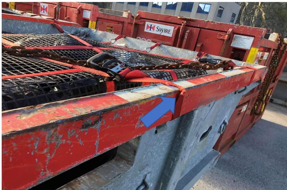
FEILMONTERING AV FIBERBÅND!
